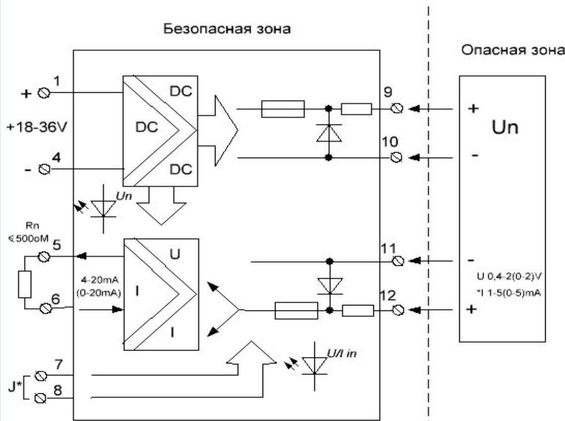
\* При установке перемычки J прибор переключается на преобразование 1-5(0-5)mA в сигнал 4-20(0-20)mA
